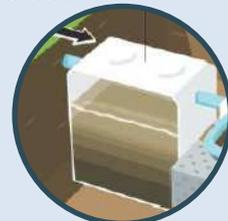
Elle est équipée d'une ventilation assurant l'évacuation des gaz de la fosse. Elle doit lorsqu'elle est suivie d'une filière compacte être précédée d'un préfiltre.
