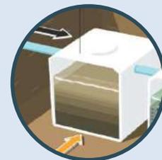
Elle peut être accompagnée d'un préfiltre ou d'un bac dégraisseur et est équipée d'un système d'extraction des boues.
