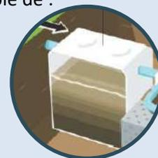
Elle peut être accompagnée d'un préfiltre ou d'un bac dégraisseur et est équipée d'une ventilation assurant l'évacuation des gaz de la fosse.
