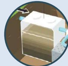
Elle peut être accompagnée d'un préfiltre ou d'un bac dégraisseur et est équipée d'une ventilation assurant l'évacuation des gaz de la fosse.
